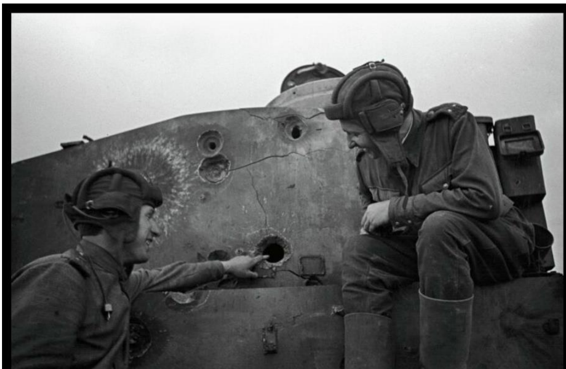
Командир танка, лейтенант Б.В. Смелов показывает пробоину в башне немецкого танка „Тигр“, подбитого экипажем Смелова, лейтенанту Лихнякевичу (подбившему в последнем бою два фашистских танка). Эту пробоину сделал обычный бронепробойный снаряд из 76-миллиметрового орудия Т-34. 23.07.1943. Автор: Наталья Бодё
